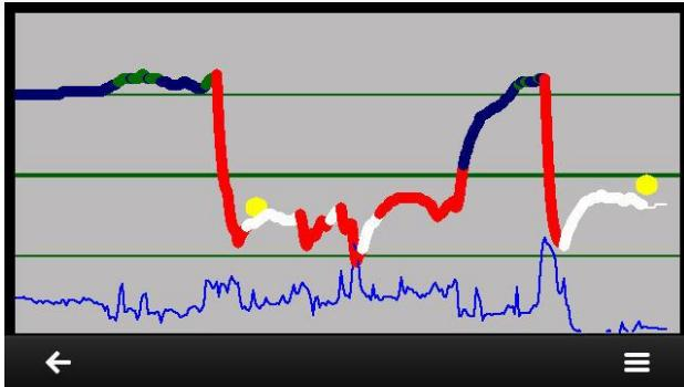
Une capture d'écran de l'interface utilisateur d'un téléphone portable dans les conditions enneigées (blanc, adhérence environ 0.45), givrantes (rouge, adhérence environ 0.35), état humide et mouillé. Les points jaunes ont été mesurés par un mètre de friction basé sur accélération installé sur le même portable.
