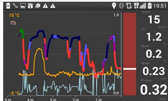
Une capture d'écran de l'interface utilisateur Android en présence de neige fondante, de verglas et en conditions mouillées et sèches (ligne violet/bleu/rouge/verte renforcée). La ligne jaune affiche la température de surface et la ligne bleu clair l'épaisseur de la couche d'eau. Le numéro 0.32 représente la valeur du coefficient de friction mesurée par le capteur optique. La barre de couleurs indique soit l'état de surface soit l'adhérence.
