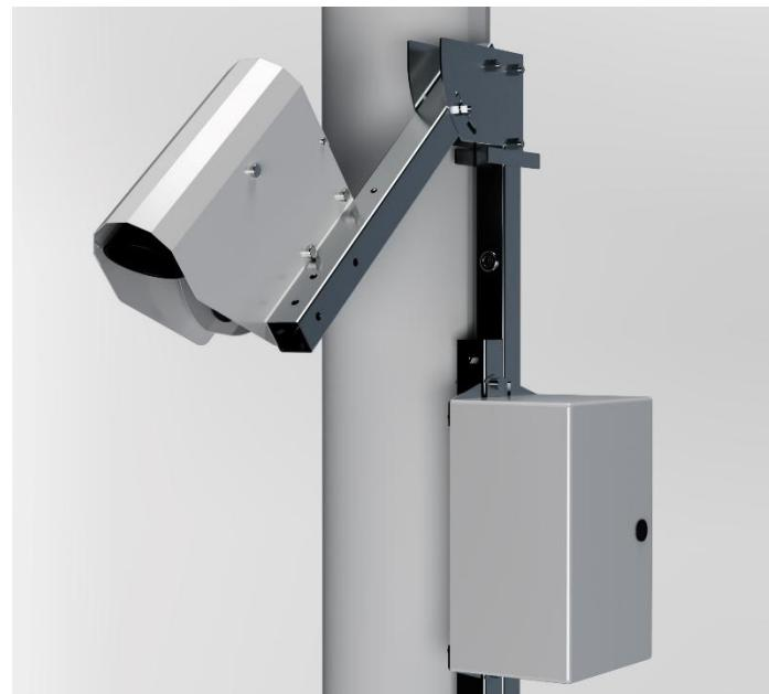
L'installation de la station météoroutière sur un poteau de l'infrastructure routière. Le fonctionnement en continu de la station est garanti par une batterie même si la puissance est prise des réverbères ou d'une autre source qui n'est alimentée que quelques heures par jour.
