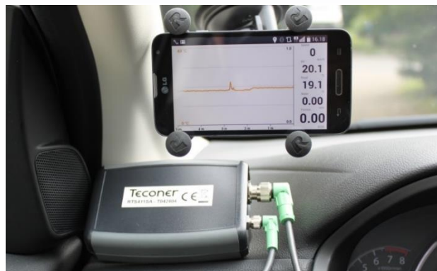
Foto sobre la interfaz de usuario con medidas de temperatura y la caja de comunicación Bluetooth en el interior del vehículo.
