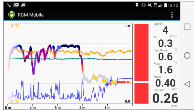
Capture d'écran de l'interface utilisateur avec les mesures de température et de l'état de chaussée.
