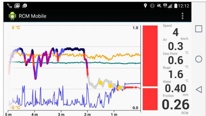
Ein Foto der Benutzeroberfläche mit Temperatur- und Fahrbahnzustandmessungen.
